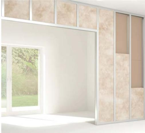
Sie sind leicht zu errichten und erlauben es, Räume individuell zu gestalten: Trennwände in Trockenbauweise, die durch Dämmplatten aus Mineralwolle sogar den Brand- und Schallschutz verbessern. Foto: Ursaltix
