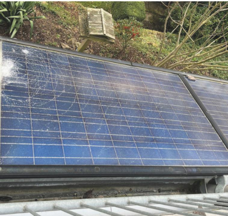
Die korrekte Fixierung von Dachpfannen mithilfe korrosionsbeständiger Sturmklammern senkt das Risiko, dass sich die Dachpfannen lösen und Photovoltaikanlagen beschädigen. (Foto: epr/ Friedrich Ossenberg-Schule/Wim Coppens)
